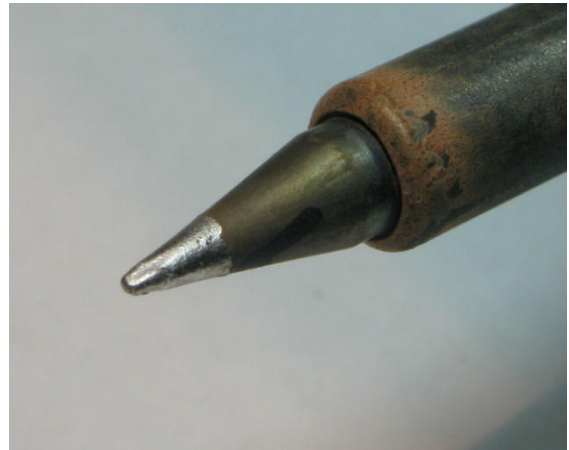
Bild 4: Sehr gut geeignete Lötspitze 0.8 mm (Lötstation: Weller WS 81 Spitze LTH)
